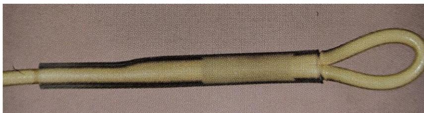
3) Con un accendino scaldare uniformemente la guaina. L'azione combinata del calore e della compressione generata dal restringersi della guaina fa fondere la plastica esterna della coda che si rimodella intorno all'asola.
